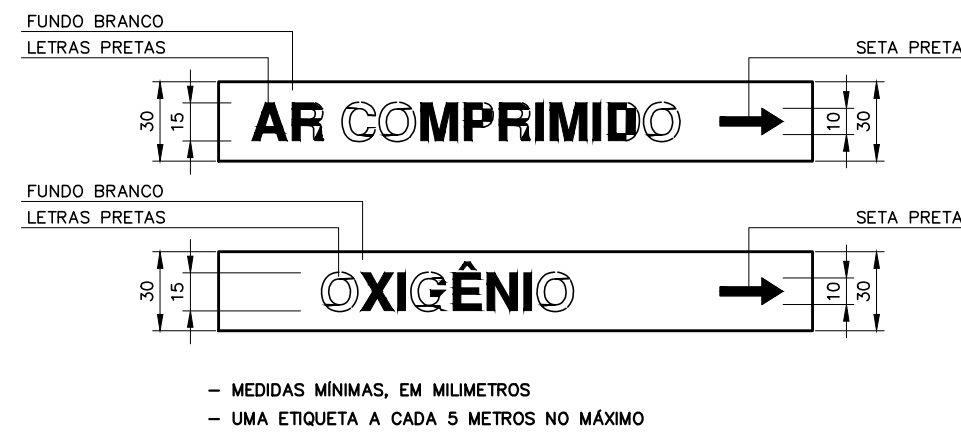
DETALHE E – ETIQUETA DE IDENTIFICAÇÃO DA TUBULAÇÃO DE GASES SEM ESCALA
